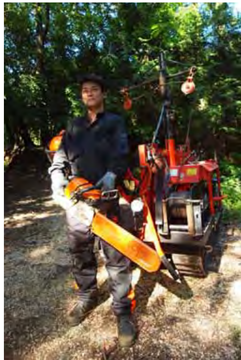
菊池林業・菊池俊一郎さん。所有機械はチェーンソーと、平成元年に買って20年以上使っている林内作業車のみと、最小投資。道づくりに必要なバックホーは「年間150日以上稼働しないなら重機は元がとれない」と考えて、使うときだけレンタルする。大型トラックも持たず、出荷の際の配送は森林組合に頼む
