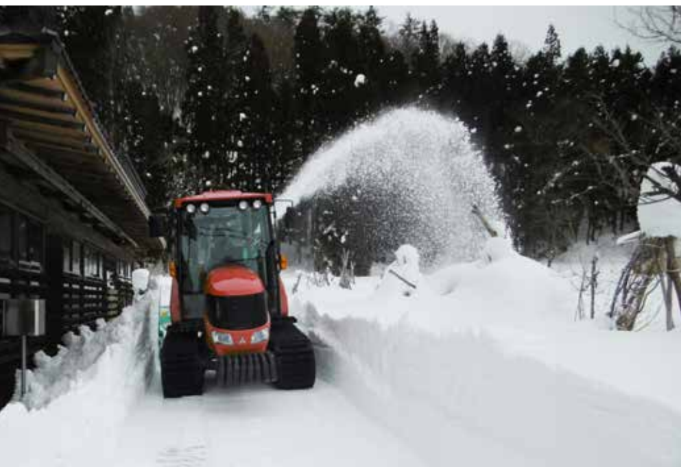
屋根の軒下にたまった雪を除雪しているところ。1シーズンに3回くらい行なう
