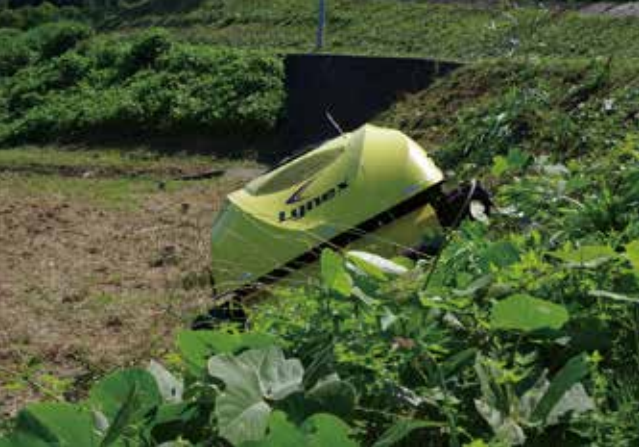
デンマーク製Lynex1000。斜面刈りが得意。ガソリンエンジンで、刃はハンマーナイフ、重量295kg
