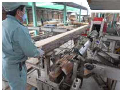
サワラを製材。節の少ないところを中心に板にする
